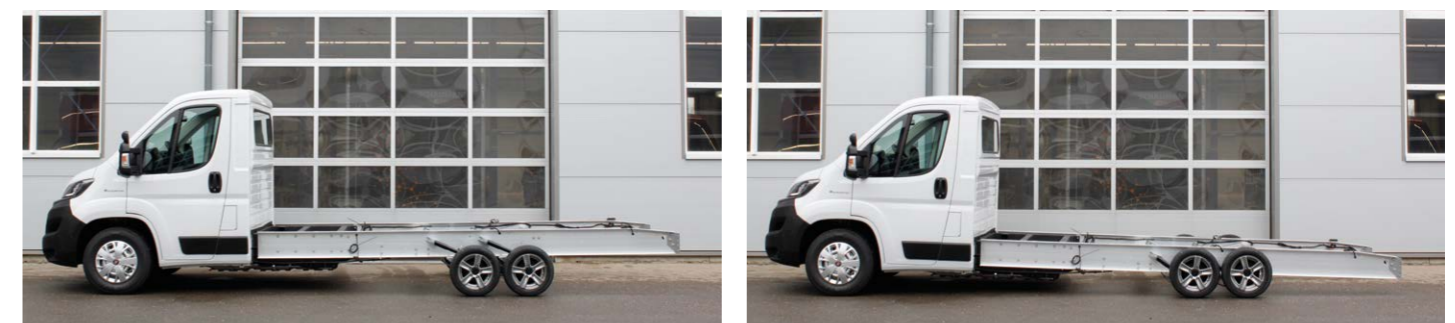
Fiat Ducato-e Chassis mit 47 kWh Batterie
