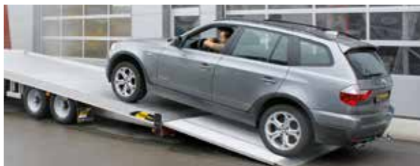
Geschlossene hydraulische Rampe
