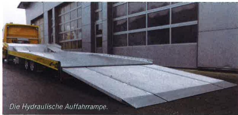
Die Hydraulische Auffahrrampe.
