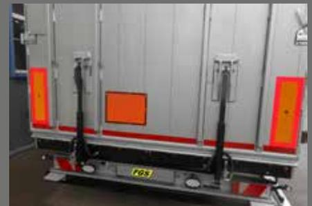
**Hydraulische Heckrampe** (Serie) mit Code XL-Zertifikat
