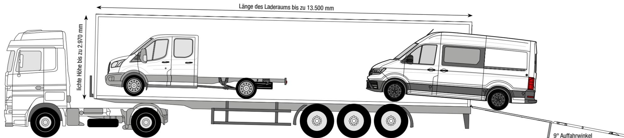
Einfachstes Be- und Entladen von PKWs, Nutzfahrzeugen oder fahrbaren Maschinen mit abgesenktem Auflieger
