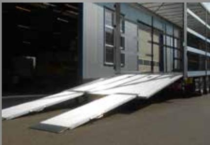
**Klapp-Zusatzrampen** (Serie) extrem flacher Auffahrwinkel von nur 9°
