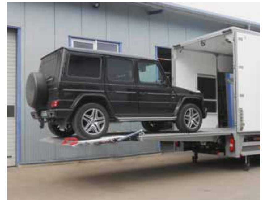
Extrem belastbar - die Hebebühne des DSRS
