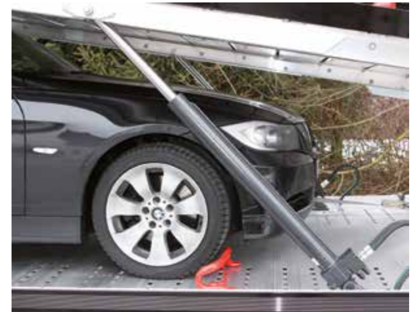
Serie in allen FGS-Doppelstocksystemen: Patentierte selbstsichernde Zylinder
