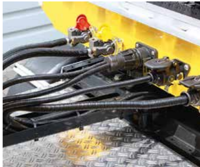
Aufgeräumt: Alle Versorgungsleitungen im drehbaren Galgen
