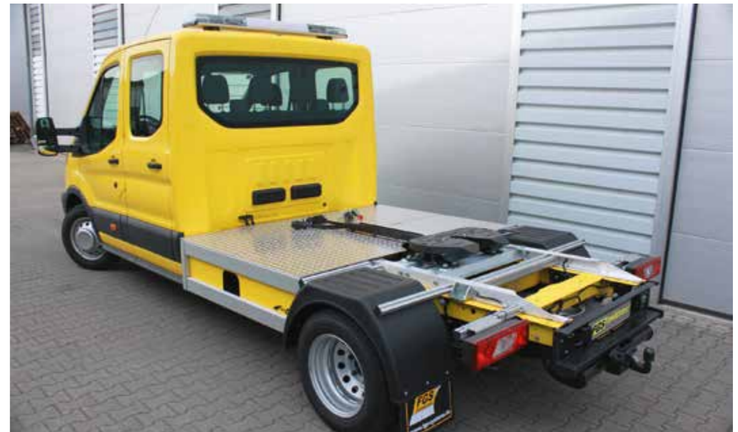
Sattelschlepper-Umbau SSU am Beispiel des Ford Transit Doka
