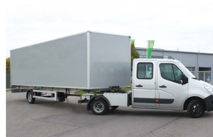
Das FGS-Aufliegerchassis ist für jeden Schlepper mit einem Mindestzuggewicht von 7,0 t geeignet
