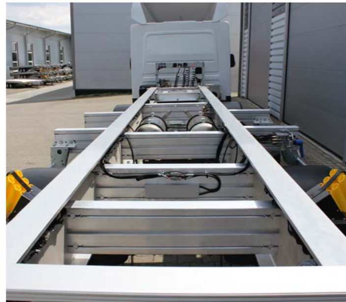
Ausgestattet wie die großen Auflieger: Auch Minisattel benötigen eine Druckluftbremsanlage
