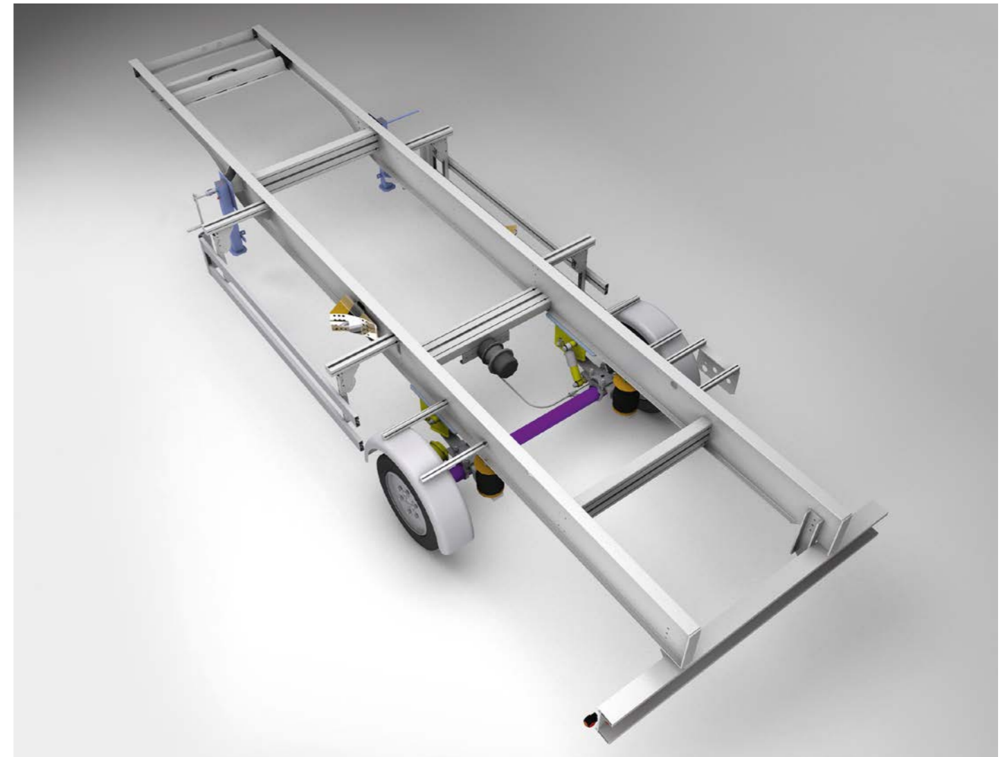
Aufliegerchassis 3,5 t mit Knottachse, Bremsanlage, Windenhubwerk, Leuchtenträger und Seitenunterfahrerschutz
