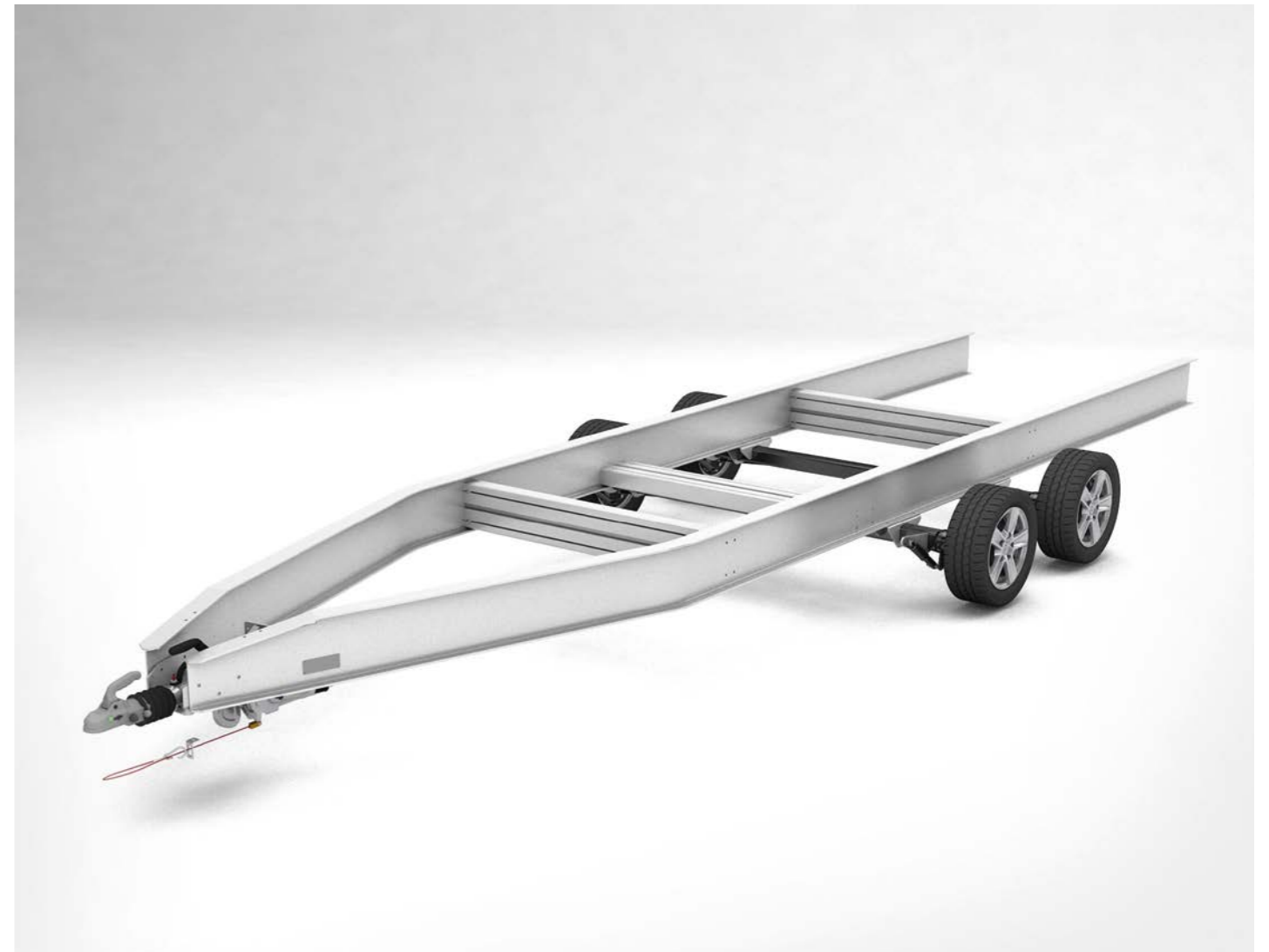
Reduziert auf das Wesentliche: CTS-Chassis mit 13" Rädern
