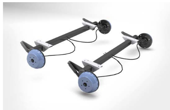
Chassis mit 14" Rädern, Ladebordwand-Vorbereitung und V-Deichsel
