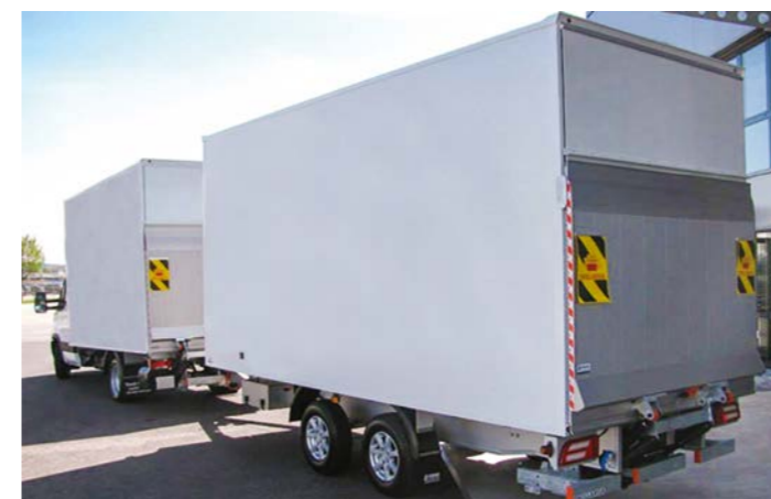
Gut ersichtlich: FGS-Vorteil – Chassis wird kundenspezifisch angepasst
