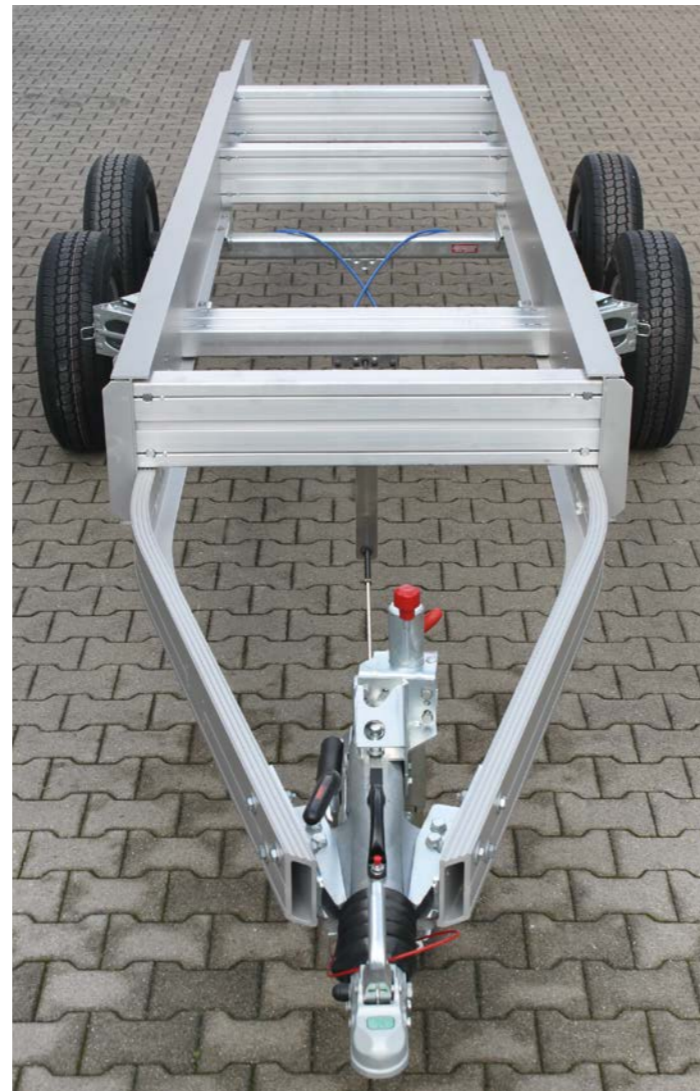
Chassis mit 14" Rädern, Ladebordwand-Vorbereitung und V-Deichsel
