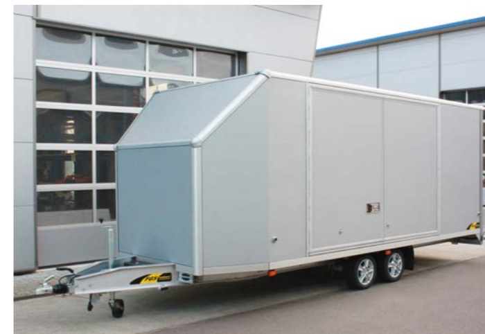
Absenkchassis TA 35 mit abgeschrägtem Heckteil
