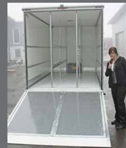
Überfahrbare, federentlastete Heckklappe auch als Kombi-Portal lieferbar
