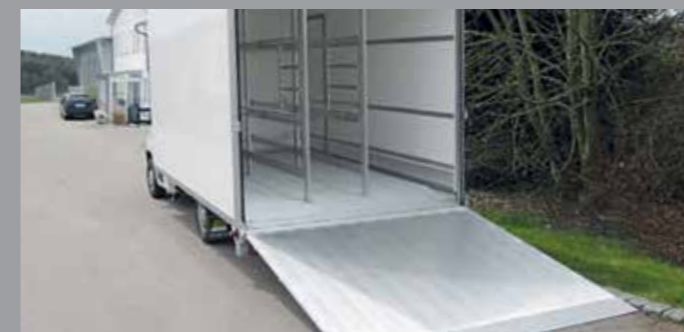
Überfahrbare, federentlastete Heckklappe auch als Kombi-Portal lieferbar
