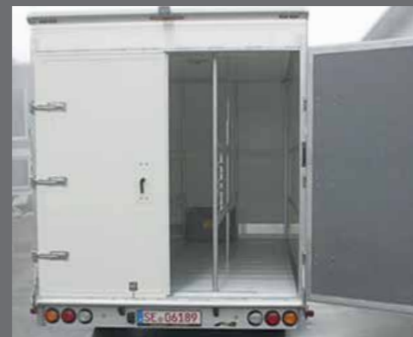
Überfahrbare, federentlastete Heckklappe auch als Kombi-Portal lieferbar
