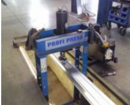
Prüfstand bis 5m und 30to Prüflast
