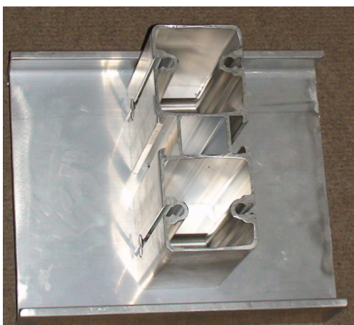
Abbildung 4.: Der neue von FGS verbesserte Querträger. 3D Model des Querträgers für eine FEM Analyse.
