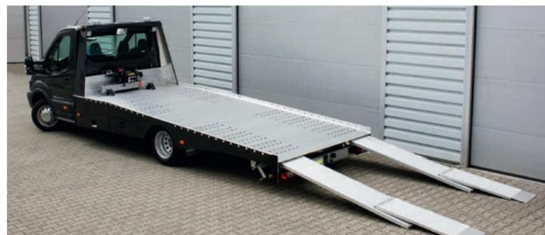
Die Rampen können manuell oder hydraulisch betätigt werden.
