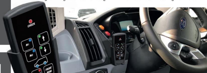
Bedienung über die herausnehmbare Remote-Control
