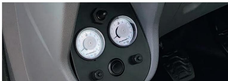
Das Bedien- und Anzeigenpanel der Zusatzluftfederung
