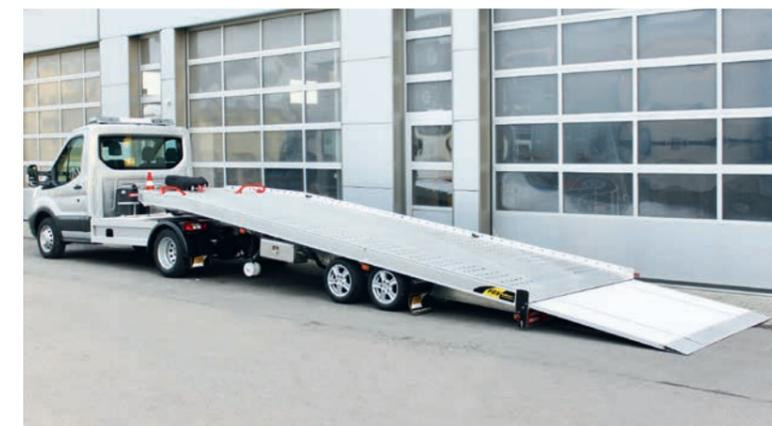
CLC im abgesenkten Zustand – verladefertig
