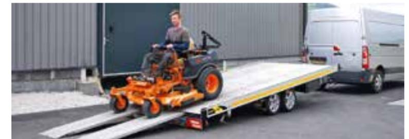
Flexibel verschiebbare Schienen für alle Spurbreiten
