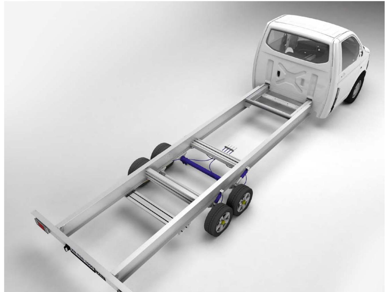
FGS Low-Liner-Chassis mit Tandemachse und hydraulischer, schneller Absenkung
