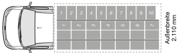
Kofferinnenlänge 4.620 mm: 31 Stapel Rack-Konfiguration 6/8/4
