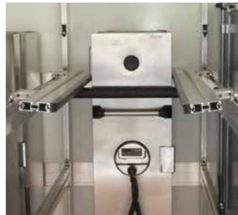
Gassen-Reduce: Klappbare Verengung zur Aufnahme von Unterschiedlichen Behältnisbreiten
