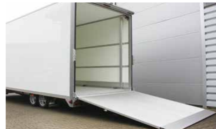
Flache Auffahrverhältnisse durch Absenktechnik
