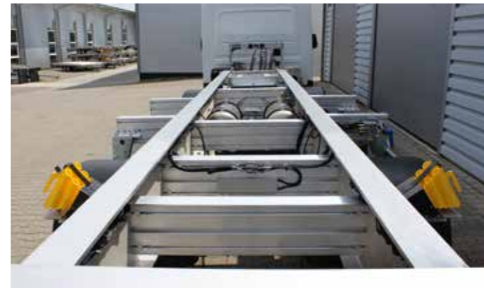
Ausgestattet wie die großen Auflieger: Minisattel mit Druckluftbremsanlage
