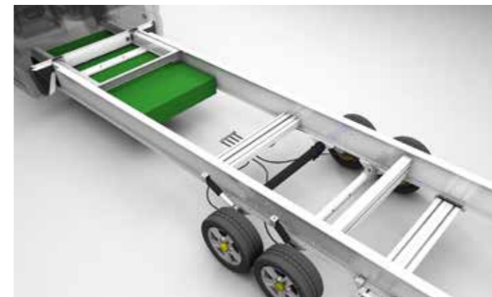
Das bewährte Low-Liner-Chassis bietet ausreichend Platz für den Batteriekasten
