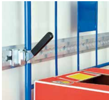
CC Halter: Robuster Halter auch für Stikkenwagen geeignet
