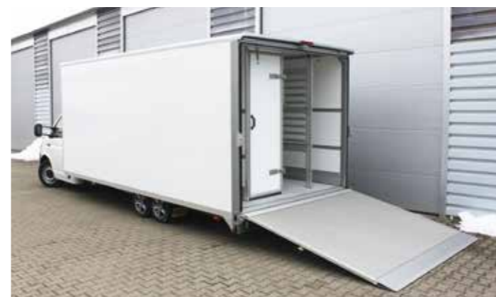
Low-Liner mit separatem Kühlteil
