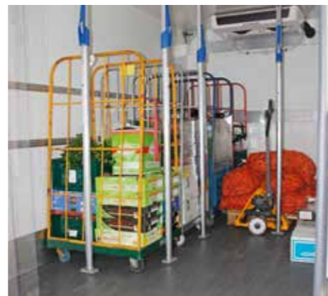
FGS-Sam: Druckstange zwischen Dach und Boden
