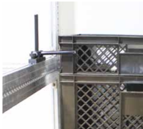
Koli-Stop: Verhindert ein Rückrollen der Stapel im abgesenkten Zustand
