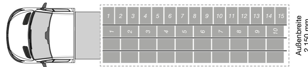
Kofferinnenlänge 6.600 mm: 45 Stapel Führerscheinklasse BE ab 19.01.2013 / Kein Sonntagsfahrverbot / Rack-Konfiguration 6/4/4/4
