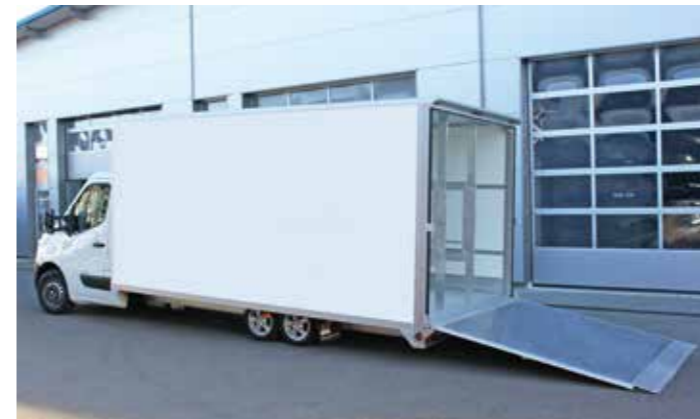
Fahrzeug abgesenkt mit geöffneter Rampe
