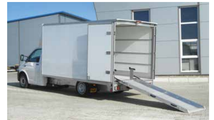
Heckportal mit Klapprampe ergibt ideale Auffahrverhältnisse
